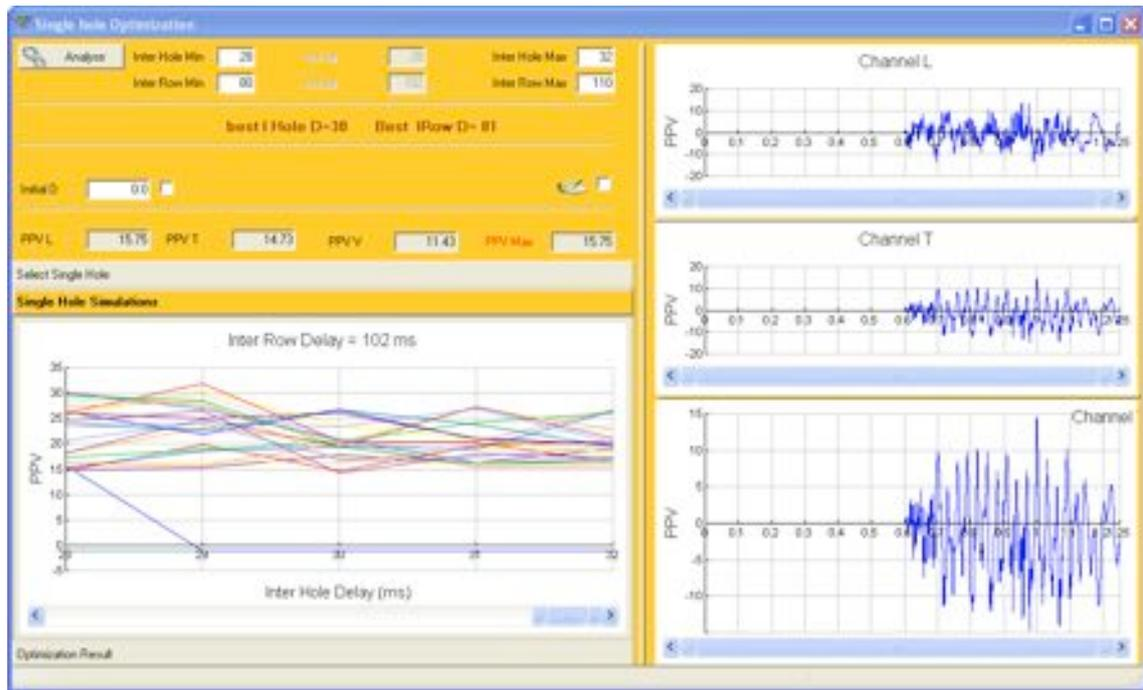
Figure 18: I-Blast - module d'optimisation par signature sismique
