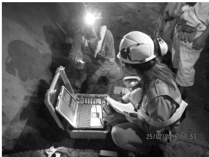
Figura 28: Ingeniero de la empresa DNA-BLAST registrando en túnel mediante el método de TSP.
